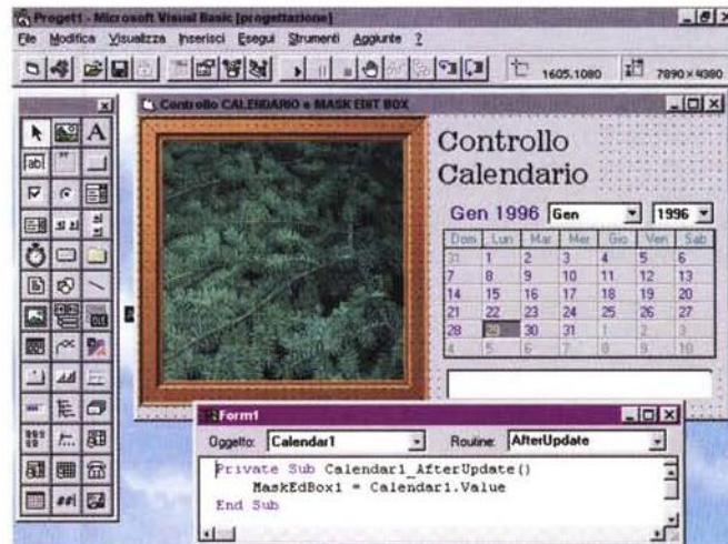
Figura 12 - MS Visual Basic 4.0 - Un piccolo calendarietto. In tutte le applicazioni in cui un utente deve scegliere una data, magari controllando quale sia il giorno della settimana, può essere usato questo simpatico controlletto: il Calendar. Il valore assunto dal Controllo quando qualcuno ci fa click sopra, è proprio la data scelta, che quindi può essere «sparata» in qualsiasi parte dell'applicazione.
